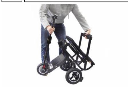
**7** ... le scooter se dépliera lorsque vous séparerez le dossier du siège et la colonne de direction et...
