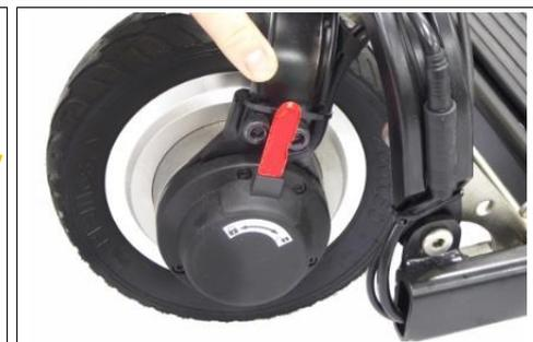
**12** Vérifiez que le frein magnétique est en position **VERROUILLÉE** pour engager le moteur.
